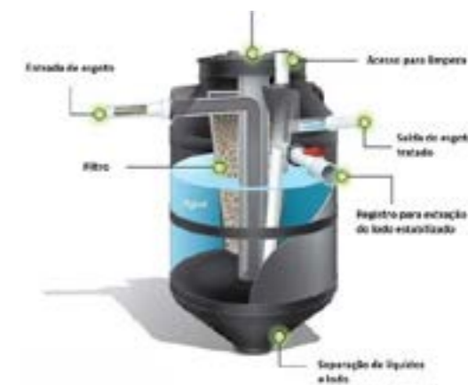
Desenho esquemático do Biodigestor Residencial. Fonte: tecnotanques.com
