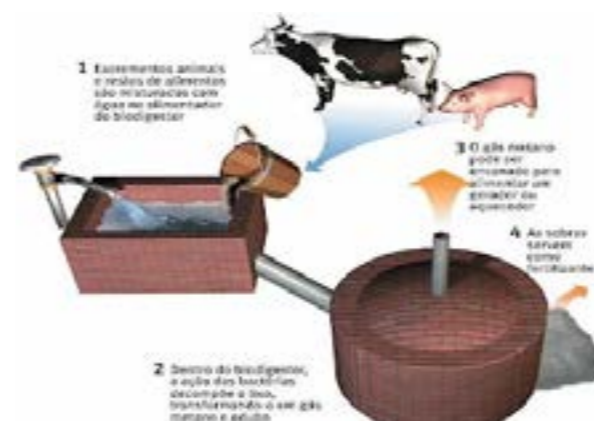
Esquema de funcionamento do Biodigestor Rural. Fonte: engquimicasantosspp.com.br
