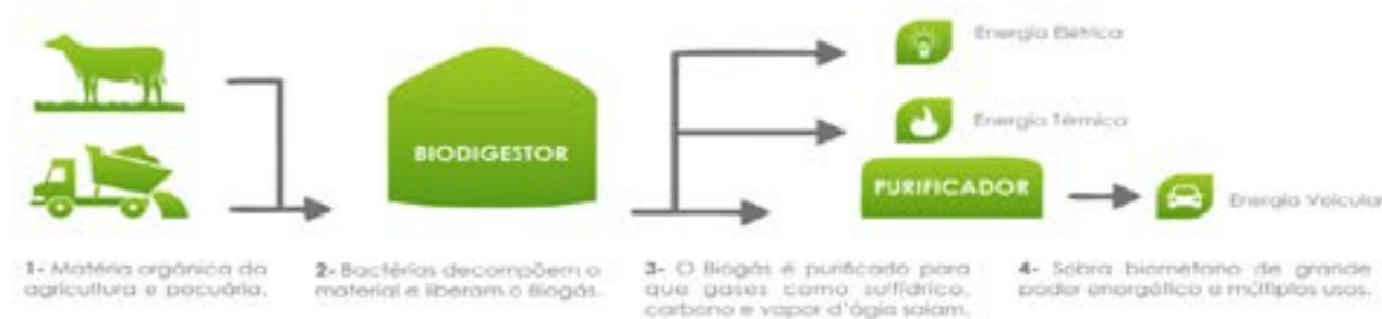
Principais componentes de um Biodigestor. Fonte: Folhito
